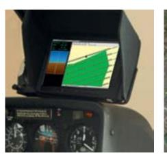
CI-DESSUS: l'écran affichant la zone à couvrir est monté au-dessus des instruments de bord de l'hélicoptère.
