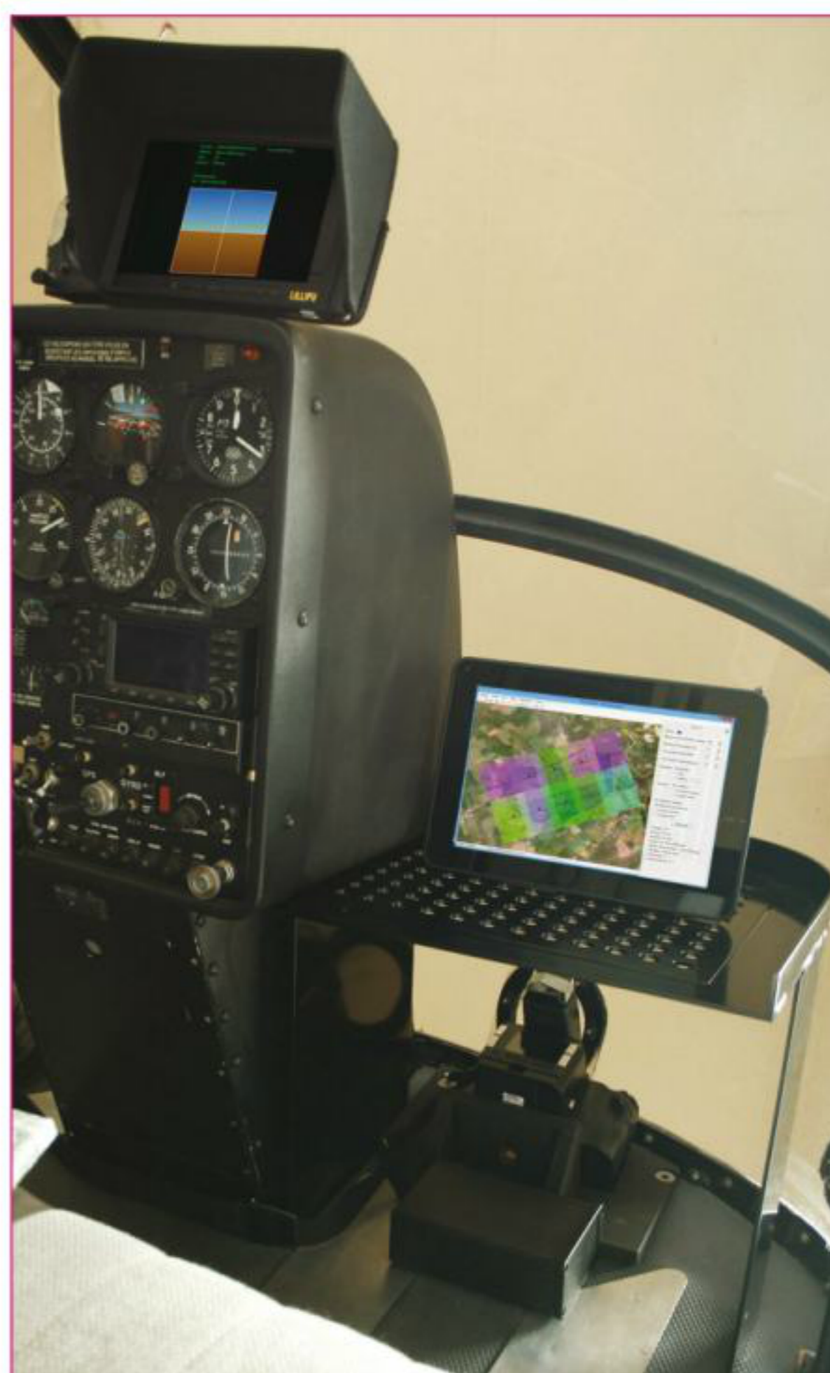
Comme dans un avion classique, le pilote et son aide disposent d'un logiciel embarqué pour situer précisément les centres géométriques de chaque prise de vue à réaliser.
